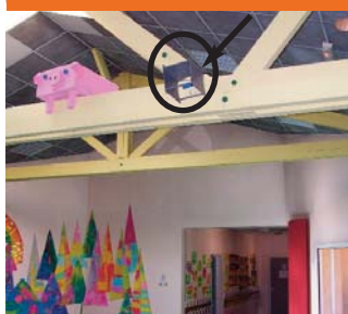
Echantillonneur passif d'aldéhyde dans la classe de l'école
